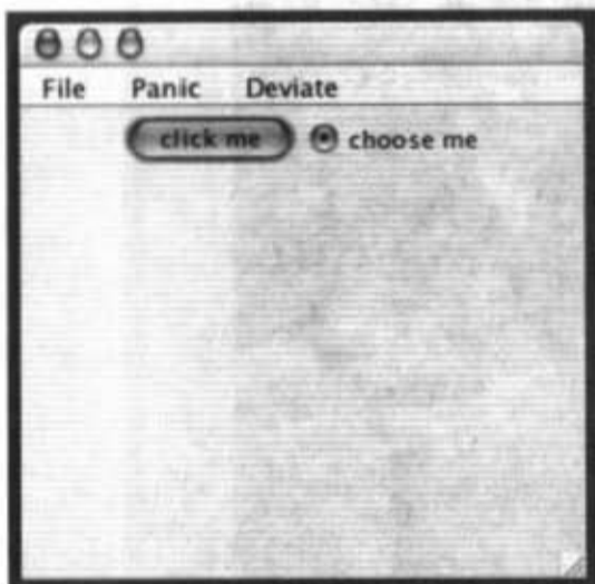
这是一个带有menu与button以及radio button的JFrame
